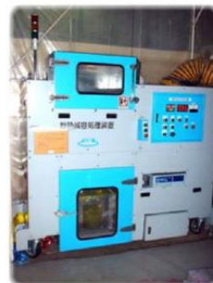
固体廃棄物の 粉碎減容処理装置
