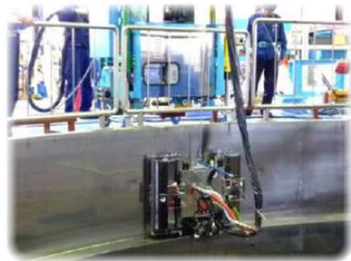
原子炉ウエル等の 壁面除染装置
