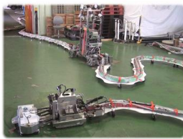
原子炉建屋床面用の 小型遠隔除染装置“RACCOON II”
